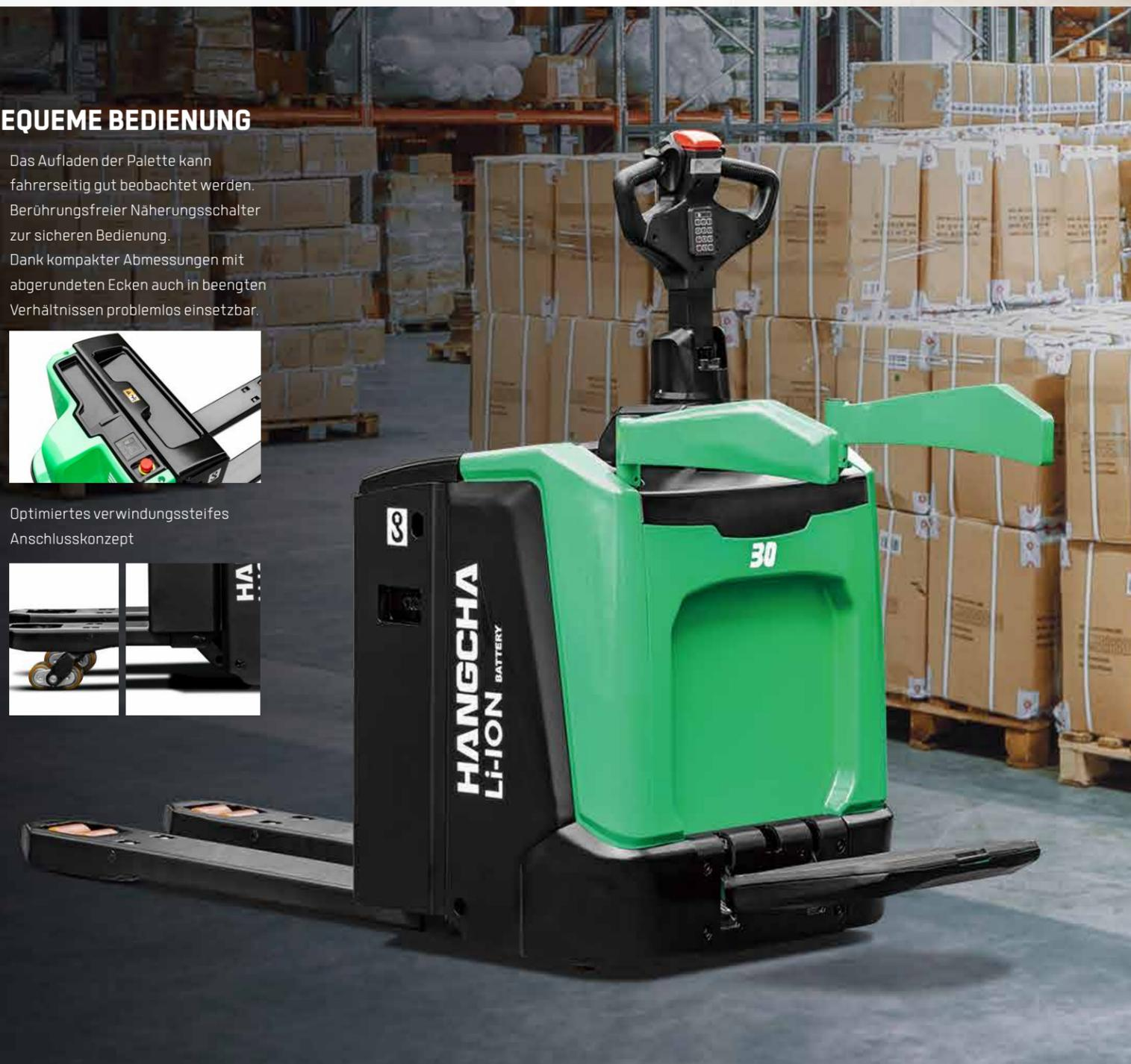
Das neue Antriebskonzept des Deichselstaplers dreht sich der Motor nicht mit der Zugstange, so dass keine Kabel gedehnt oder verbogen werden.
