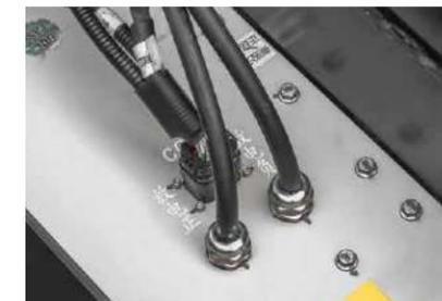
Wasserdichtes Gesamtkonzept zum Schutz der Elektrik.
