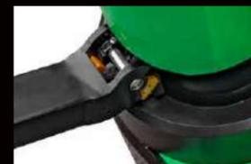
Deichselstapler mit neuem Antriebskonzept und geändertem Aufbau, so dass keine Kabel gedehnt oder gebogen werden.
