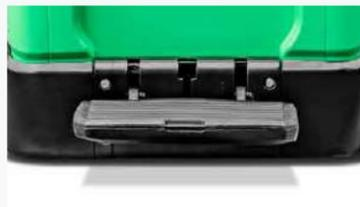
Das Pedal wurde an stehenden Fahrbetrieb angepasst und beugt Ermüdung vor.
