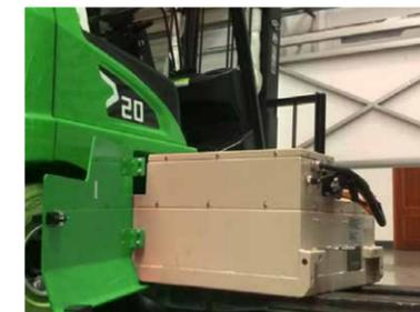
Der Batteriepack ist auf Rollen gelagert und lässt sich einfach auf einen Hubwagen ziehen für Wartung oder Wechsel.
