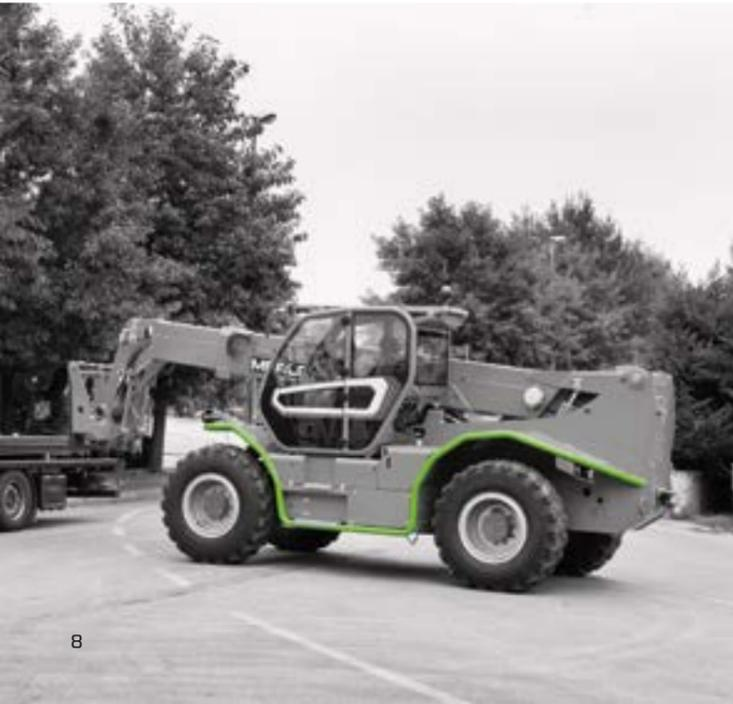
Das Sicherheitssystem ASCS (Adaptive Stability Control System) sorgt für optimierte und sichere Arbeitseinsätze.
