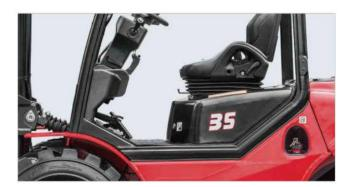
Der leicht zu öffnende Haube ermöglicht einen schnellen Zugang zum Motorraum.
