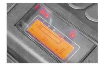
Das neu entwickelte LCD-Instrument verfügt über umfassendere Funktionen, eine stabilere Leistung und kann den vollständigen Status, den Fehlercode und andere wichtige Informationen des Staplers vollständig anzeigen, sodass der Bediener den Status intuitiver verstehen kann und erleichtert die Wartung.
