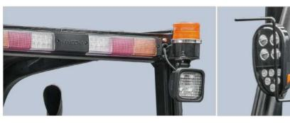
Das neue Effizienzbeleuchtungssystem verwendet LED-Leuchtmittel und einen neuartigen Reflektor, um den Energieverbrauch zu senken und die Beleuchtungsleistung erheblich zu verbessern.
