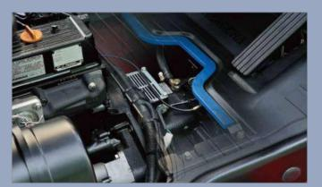
1. Neben dem Gummidämpfer zwischen Rahmen und Lenkachse erreichen der Verbundmotordämpfer und der vollschwimmende Antriebsstrang eine flexible Verbindung zwischen Rahmen und Antriebssystem, wodurch Fahrvibrationen des Antriebssystems erheblich reduziert werden, system are significantly reduzed.
