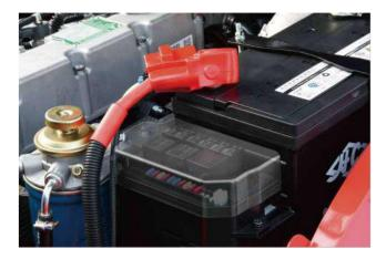
Die Verwendung einer neuen Generation von integrierten Schaltkästen erleichtert die Wartung und Reparatur, das Layout wird einfacher und bietet eine bessere Wasserdichtigkeit.
