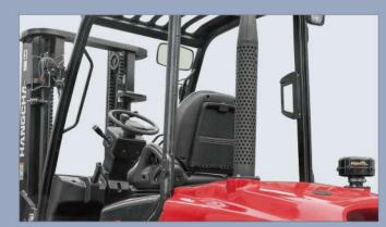
**4.** Aufgrund des größeren Abstandes zwischen den inneren Masten bietet der Gabelstapler eine breite Sicht nach vorne.
